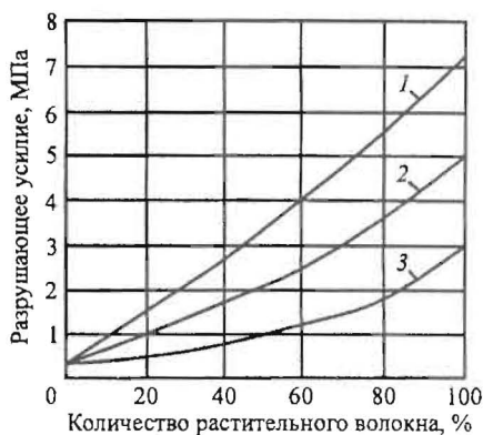
Рис. 3. Результаты введения в качестве связующих растительных волокон: 1 – хлопковая целлюлоза, 2 – древесная целлюлоза, 3 – макулатура
