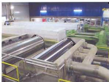
Рис. 5. Цех локальной физико-химической очистки стоков БХТММ и обезвоживания осадков (на переднем плане — барабанные решетки, на втором плане — обезвоживающие пресса)
