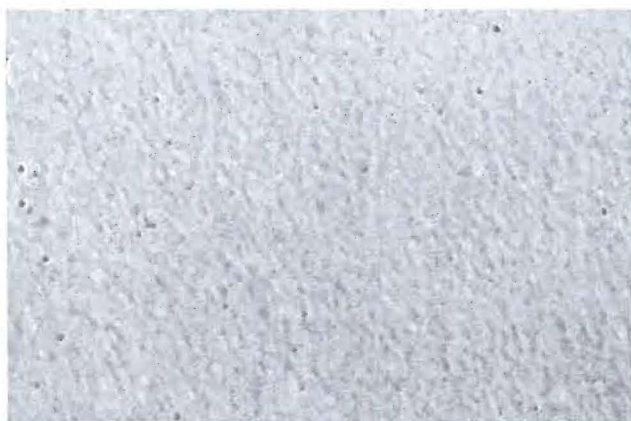
Рис. 6. Электронная микрофотография стекол, полученных спеканием органо-неорганических гибридных ксерогелей, синтезированных из фосфатных комплексов лантаноидов, химически связанных с кремнеземной матрицей.
