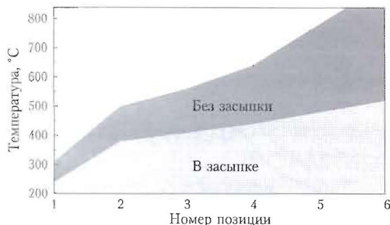
Рис. 3. Температурный режим в туннельной печи цеха ОАО СОЗ при обжиге изделий без засыпки и в засыпке. Номер позиции кратен 6 ч
