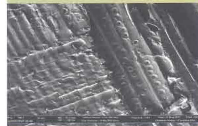
Рис. 24. Радиальный скол. Образец средней части ядра обработан горячей водой Масштаб — 20 мкм
