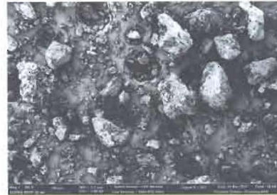
Рис. 1. Порошок арабиногалактана Масштаб: — 100 мкм
