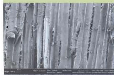
Рис. 16. Тангентальный скол. Периферийная часть ядра Масштаб: — 20 мкм
