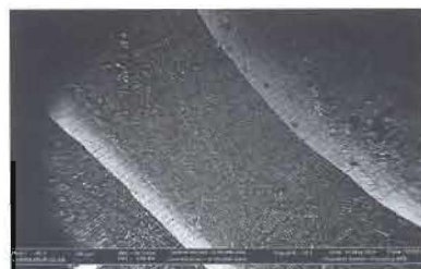
Рис. 21. Торцевой срез. Образец центральной части ядра обработан горячей водой Масштаб — 200 мкм
