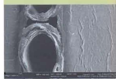
Рис. 19. Тангентальный скол. Образец заболони обработан горячей водой Масштаб — 1 мкм
