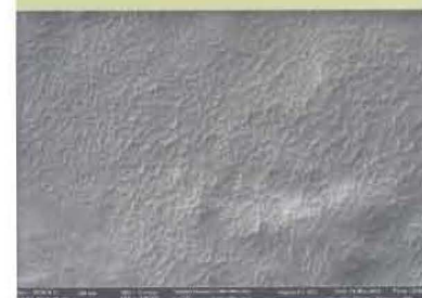
Рис. 4. Пленка из раствора арабиногалактана, высушенного на подложке Масштаб: — 200 нм
