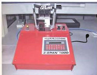
Рис. 4. Прибор для измерения прочности отдельных волокон, как в сухом, так и во влажном состоянии «Zero-Span 1000»
