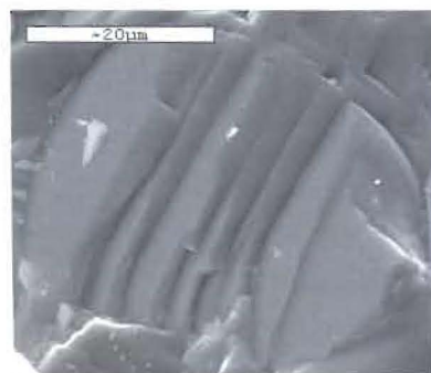
Рис. 5. Сканирующая электронная микроскопия CaO, обожженного при 2200°C. Увеличение x10000.
