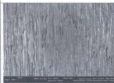
Рис. 4. Тангентальный разрез. Сосна. Заболонь. Масштаб — 100 мкм
