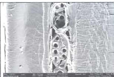
Рис. 10 Тангентальный разрез. Лиственница. Ядро. Масштаб — 2 мкм
