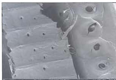
Рис. 9 Радиальный разрез. Лиственница. Ядро. Масштаб — 10 мкм
