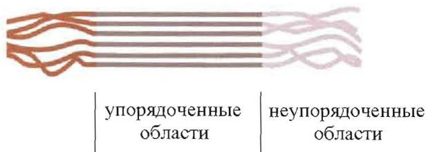
Рис. 3. Схематичное представление структуры полупорядоченного полимера одной конформации
