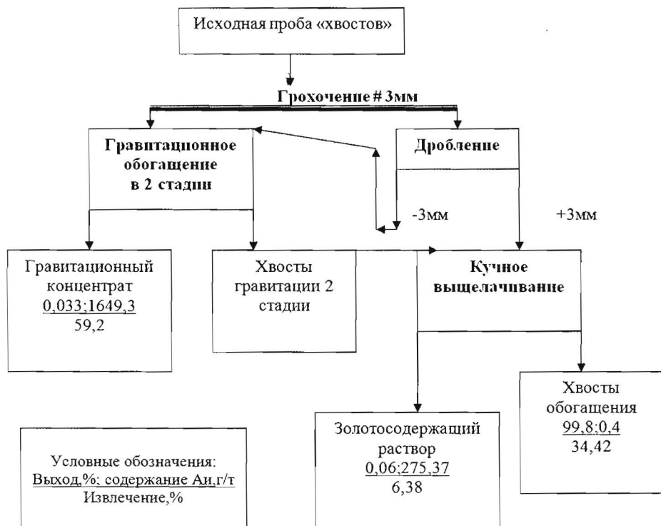
Рис. 1. Рекомендуемая схема переработки гале-эфельных отвалов
