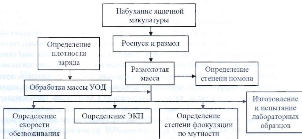
Рис. 1. Схема исследования влияния УОД на бумажную массу из макулатуры
