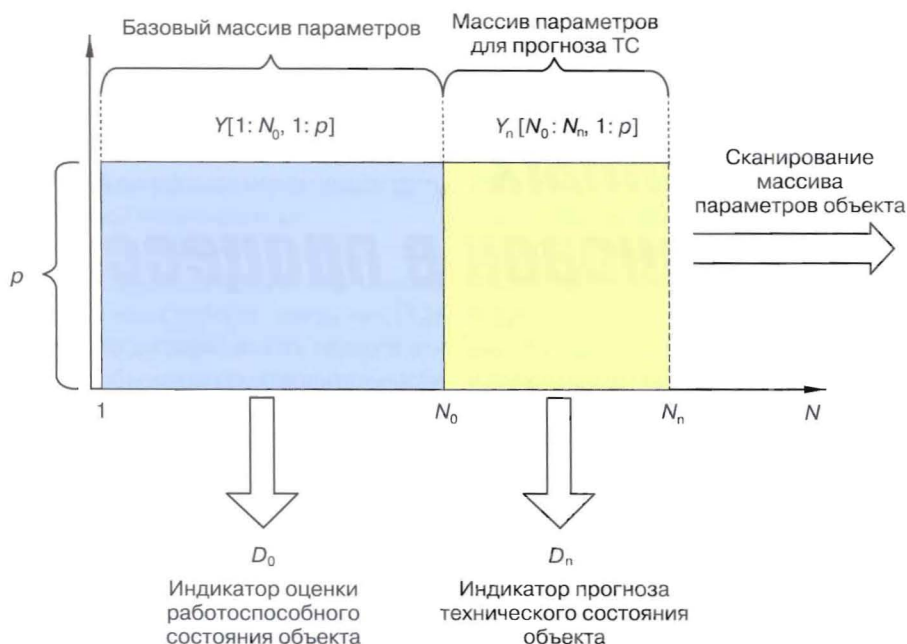
Рис. 1. Структура массива параметров газотурбинного двигателя
