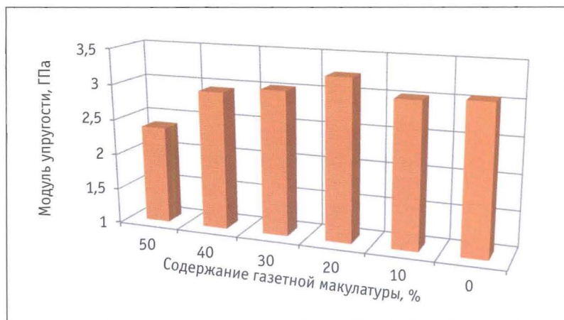
Рис. 4. Зависимость модуля упругости от содержания волокон из газетной облагороженной макулатуры в трехслойной отливке.
