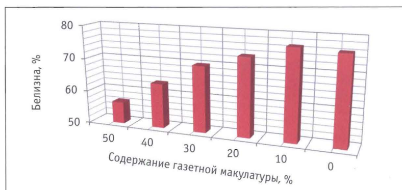
Рис. 2. Зависимость белизны трехслойной отливки от содержания облагороженной газетной макулатуры в среднем слое трехслойного вайт-лайнера.
