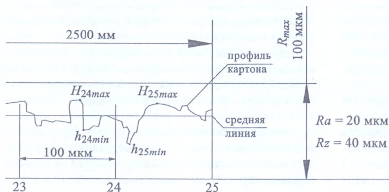
Рис. 5. Определение шероховатости многослойного картона по анализу изображений профиля (23, 24, 25 – число профилей) поперечного среза многослойного картона.
