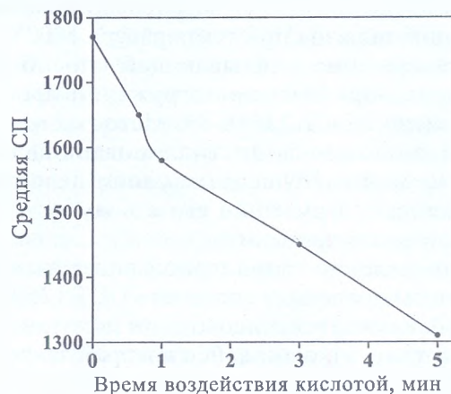
Рис. 3. Зависимость степени полимеризации от времени воздействия серной кислоты. Концентрация кислоты 10 %.
