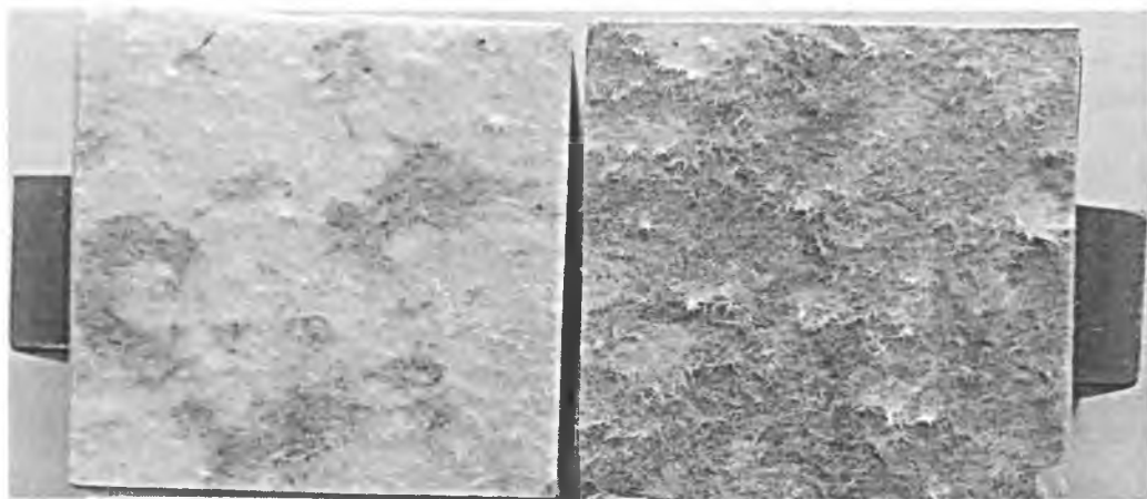
Рис. 8. Расслаивание двухслойного тест-лайнера с белым покровным слоем, полученного традиционным мокрым способом
