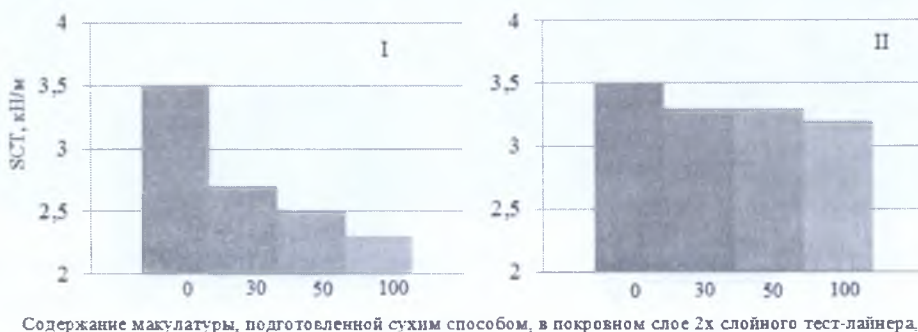
Рис. 3. Зависимость сопротивления сжатию на коротком расстоянии от содержания макулатуры, подготовленной сухим диспергированием в покровном слое двухслойного тест-лайнера ( 120 \text{ г/м}^2 ): I – сухое диспергирование с подачей в массу; II – сухое диспергирование и размол в водной среде
