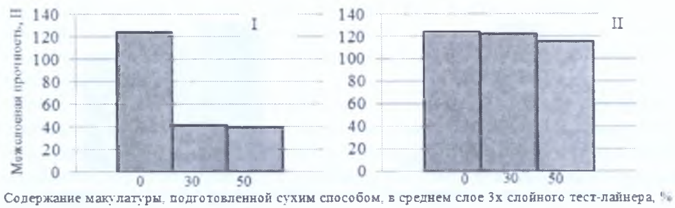
Рис. 6. Зависимость сопротивления расслаиванию от содержания макулатуры, подготовленной сухим диспергированием в среднем слое трехслойного тест-лайнера (150 г/м²): I – сухое диспергирование с подачей в массу; II – сухое диспергирование и размол в водной среде
