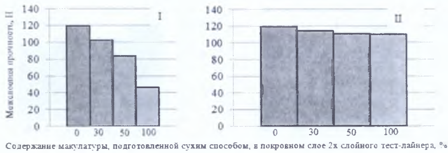
Рис. 7. Зависимость сопротивления расслаиванию от содержания макулатуры, подготовленной сухим диспергированием в покровном слое двухслойного тест-лайнера (120г/м²): I – сухое диспергирование с подачей в массу; II – сухое диспергирование и размол в водной среде
