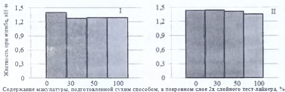
Рис. 4. Зависимость жесткости при изгибе от содержания макулатуры, подготовленной сухим диспергированием в покровном слое двухслойного тест-лайнера ( 120 \text{ г/м}^2 ): I – сухое диспергирование с подачей в массу; II – сухое диспергирование и размол в водной среде
