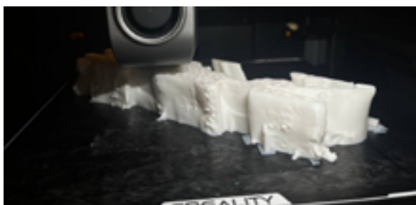
Рисунок 11. Процесс изготовления фрагмента микроструктуры картона
